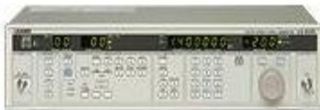
Fig8. Generador de R.F.
