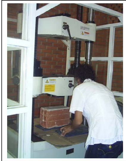
Figura 6. Preparación Ensayo Compresión.
