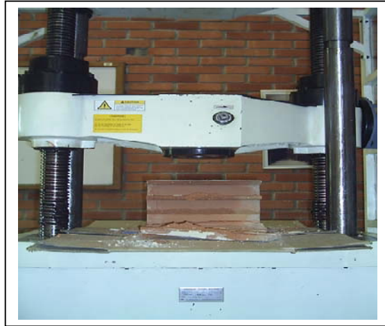
Figura 8. Falla de Compresión Máquina Universal.
