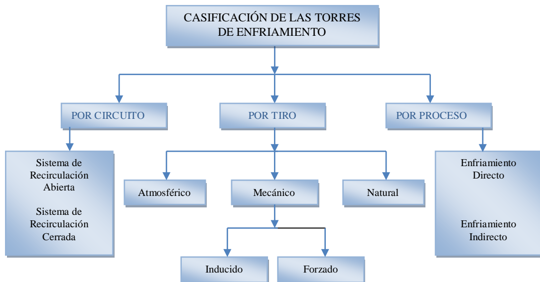
Figura 5. Clasificación de las Torres de Enfriamiento. [9]
