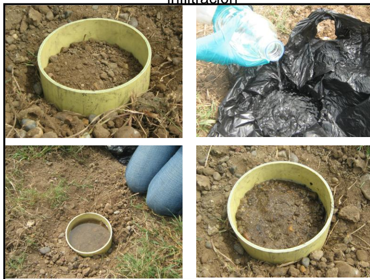
Fotografía 10. Prueba de permeabilidad e infiltración in situ. Se observa el procedimiento que se llevó a cabo para realizar in situ el ensayo de permeabilidad e infiltración
