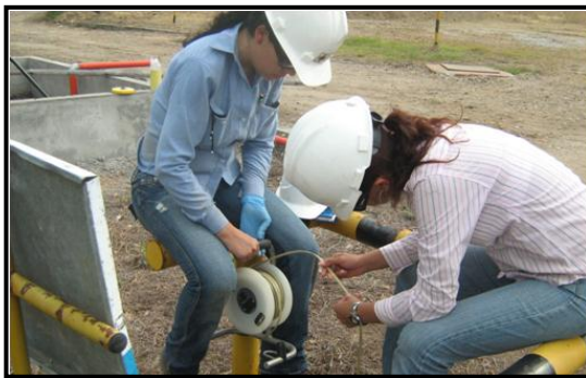
Fotografía 2. Medición de niveles estáticos. Se observa la sonda para mediciones de niveles estáticos.
