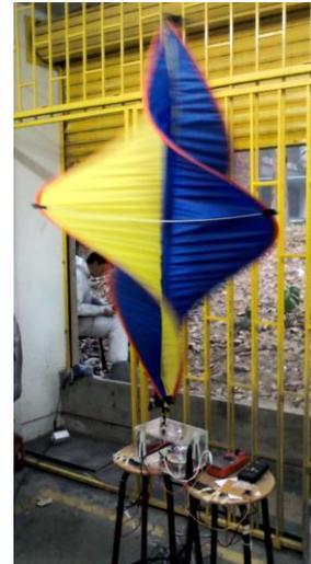
Fig. 12. Prototipo de aerogenerador tipo Savonius de radio 40 cm
