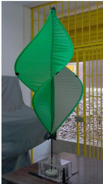
En la Figura 40 se observa que a medida que la velocidad del viento aumenta, de igual forma aumenta la velocidad de rotación del aerogenerador cuando no se aplica ninguna carga eléctrica alcanzando valores cercanos a 100 RPMs cuando la velocidad del viento es superior a 4 m/s, esto es debido a que el dinamo mantiene su torque constante. La gráfica de la Figura 40 es el resultado de un promedio entre tres pruebas realizadas bajo los mismos parámetros.
