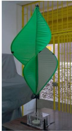
Fig. 7. Prototipo de aerogenerador tipo Savonius de radio 30 cm
