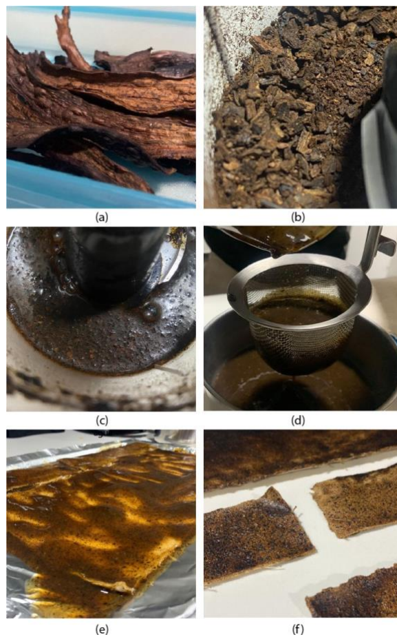
Figura 1. Proceso de obtención del plástico y de la celulosa. (a) Cáscaras de banana deshidratadas. (b) Cáscaras de banana pulverizadas. (c) Mezcla polvo de cáscaras de banana y agua. (d) Celulosa colada. (e) Bioplástico obtenido. (f) Material modificado con bioplástico
