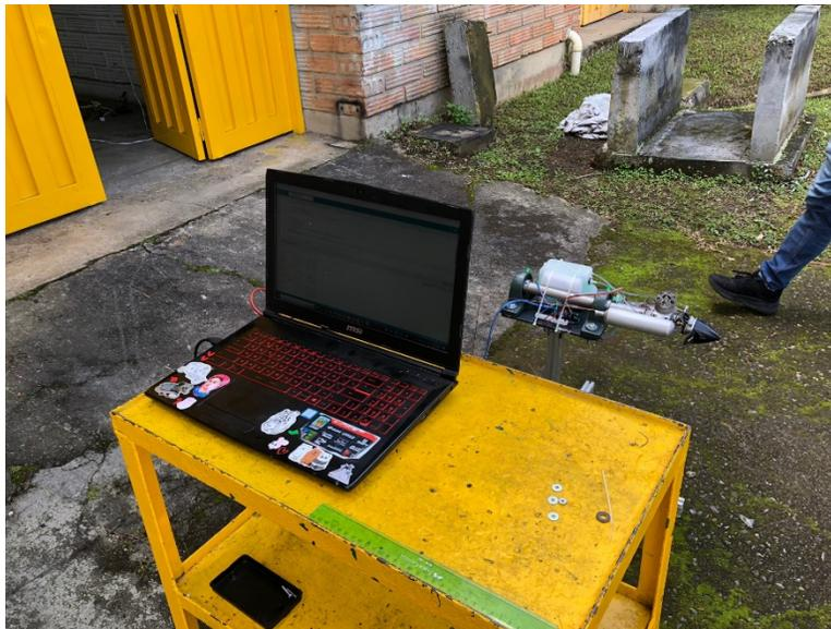
*Figura 20, montaje para las pruebas del motor.*
