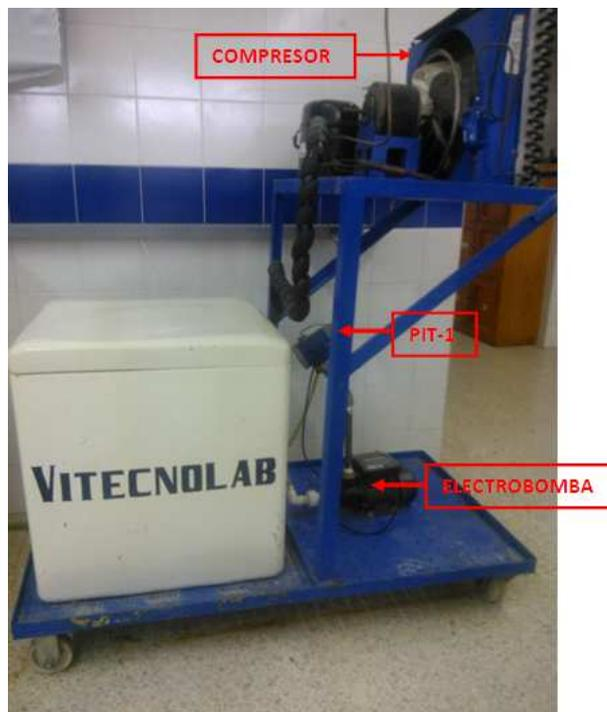
**Figura 41: Componentes sistema de refrigeración.**
