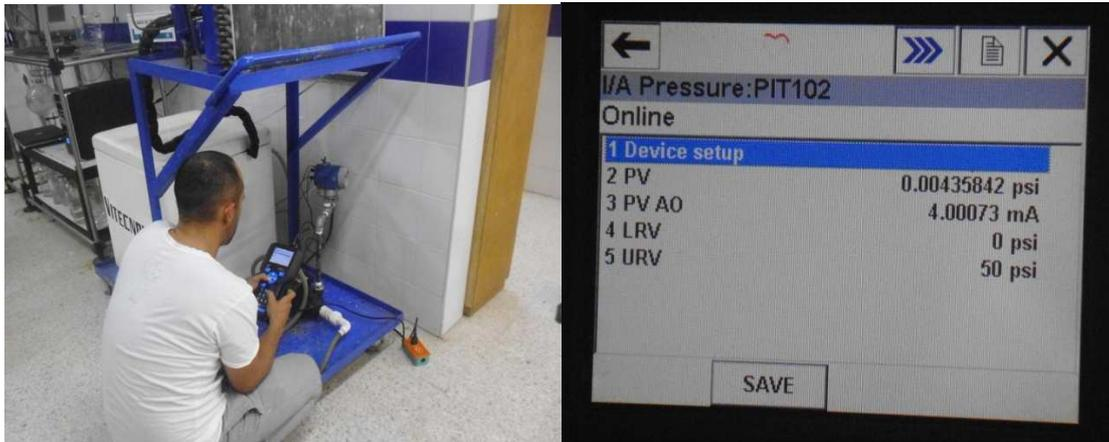
**Figura 29: Configuración del transmisor de presión a través de protocolo HART.**
