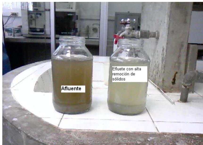
En la anterior imagen se observa la muestra de agua del afluente y del efluente respectivamente, tomada el día 13 de julio de 2009, aproximadamente 20 días después de concluir el periodo de adaptación del lodo.
